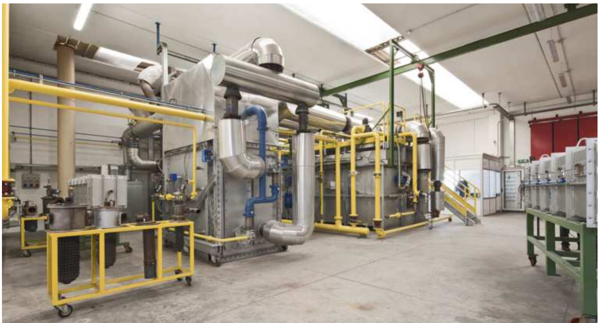
Una vista del forno fisso F1 con preriscaldatore aria di combustione in Curno (Bergamo) - Italia
